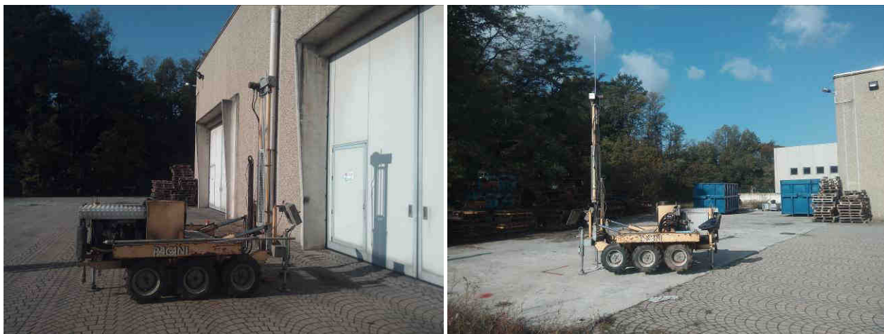
Penetrometro superpesante tipo Meardi AG utilizzato per l'indagine eseguita
